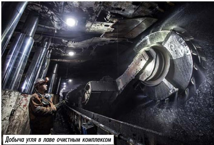
Добыча угля в лаве очистным комплексом
